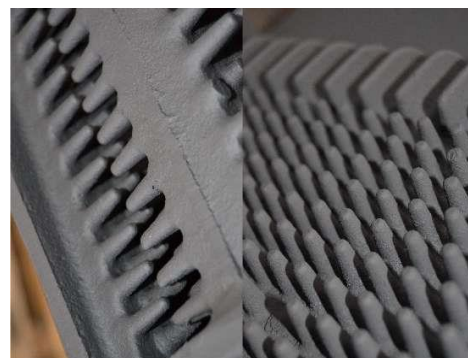
Рисунок 1. Внешний вид поверхностей теплообменника
